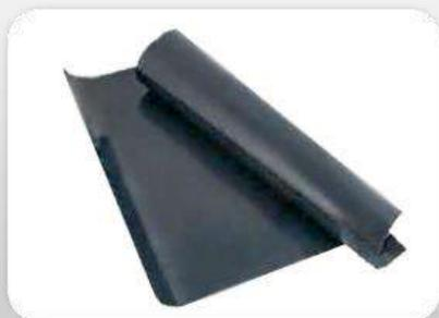
Vitriflon® Serie VTF-600 series conductiva o antiestático constituido con una base de 60 a 80% de tela de Fibra de Vidrio recubierto de una película delgada de 20 a 40% de PTFE (teflón) pigmentado de color negro de una calidad Premium utilizado para la fabricación de hojas de liberación, cinturones de máquinas de fusión u otras aplicaciones que requieran propiedades disipativas estáticas.
